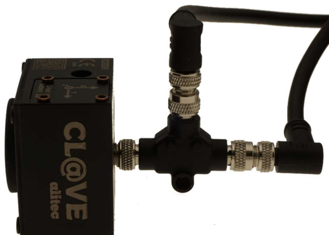
Rys. 23. Przykładowe wykorzystanie rozdzielacza sygnałów
