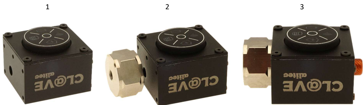
Rys. 16. Przymocowanie magnesu do czujnika
